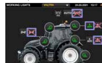
Configurez facilement les phares de travail avec l'écran tactile de 9 pouces. Les phares de travail Premium et Premium+ incluent également des feux de virage réglables, qui sont commandés par le capteur d'angle de braquage dans le pont avant.
